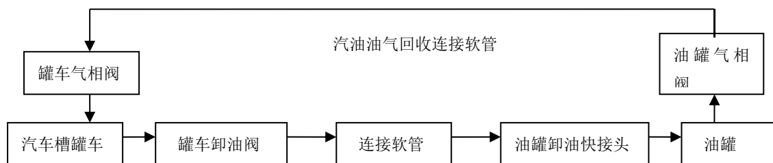
图 2-2 汽油卸油工艺流程示意图
