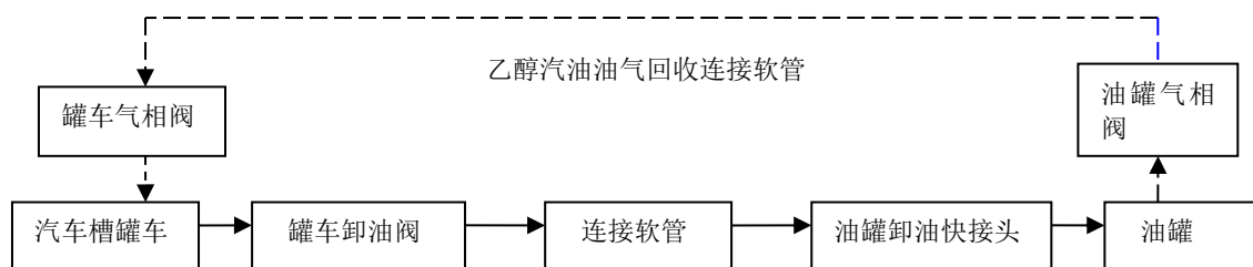
图 2-2 乙醇汽油卸油工艺流程示意图
