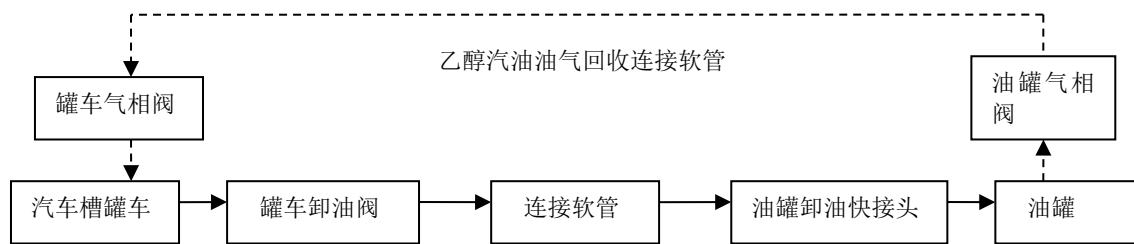
图 2-1 乙醇汽油卸油工艺流程示意图
