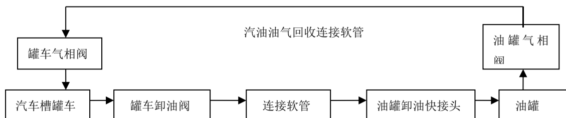
图 2-2 汽油卸油工艺流程示意图
